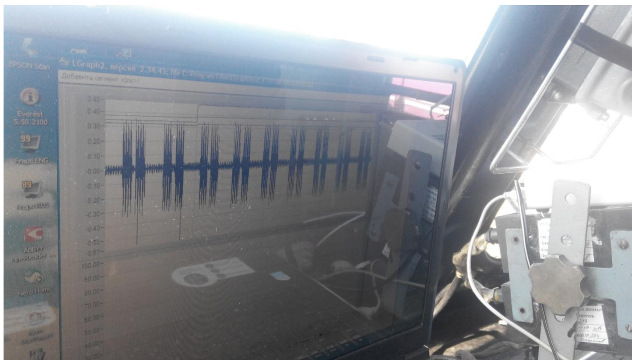
Рисунок 4.12 – Робоче вікно програми LGraph2 при прийомі кодового сигналу «Ж» зі шлейфу
