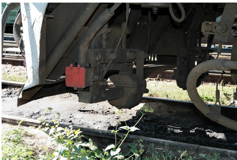
Рисунок 2.12 – Місце розташування приймальних котушок на локомотиві
