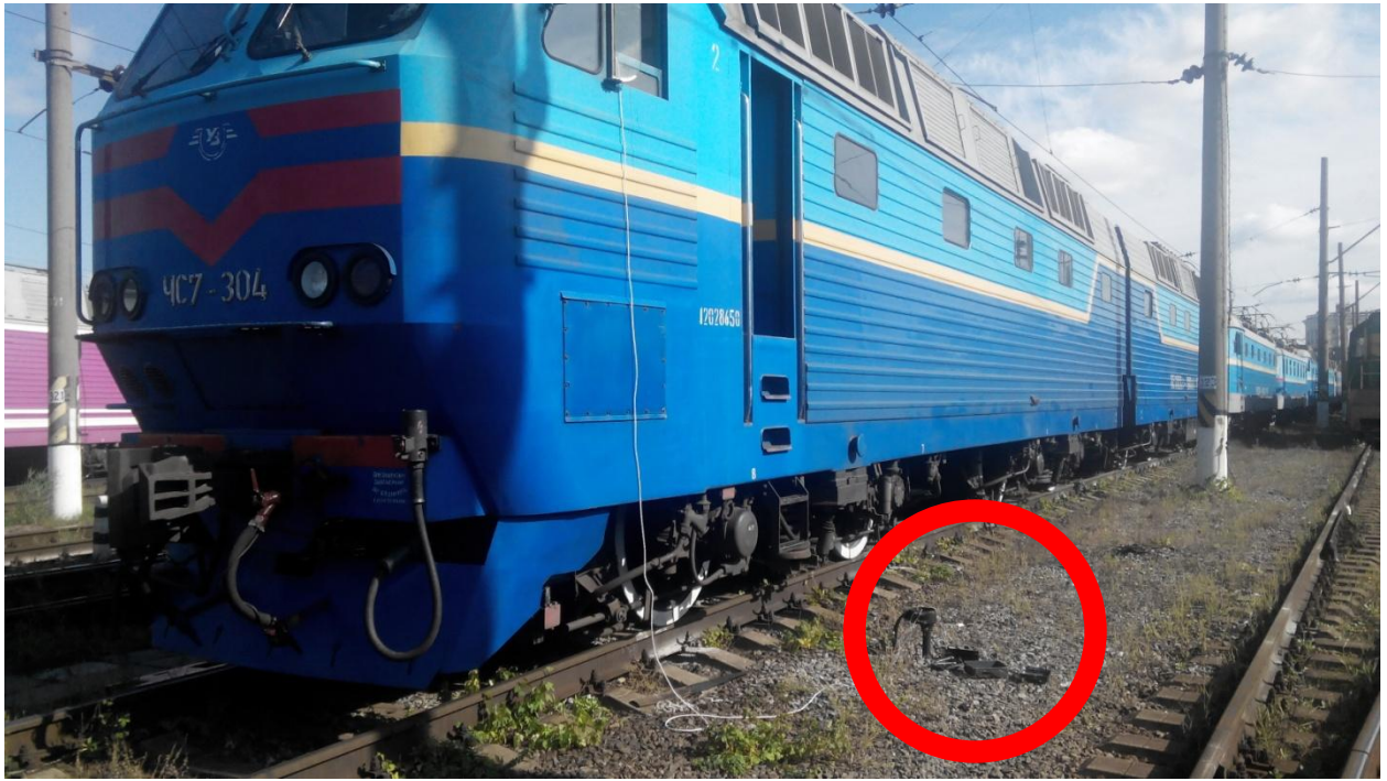
Рисунок 4.6 – Заведення живлення шлейфу з муфти розгалудження вимірювальної ділянки до кабіни локомотива для підключення до пристрою контролю
