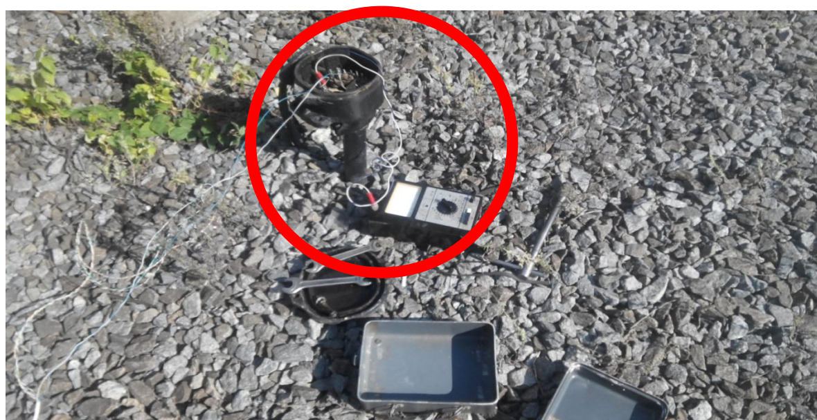
Рисунок 4.9 – Вимірювання напруги у випробувальному шлейфі
